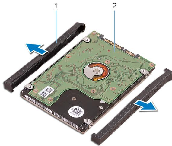
**图 10: 卸下硬盘驱动器护盖**
