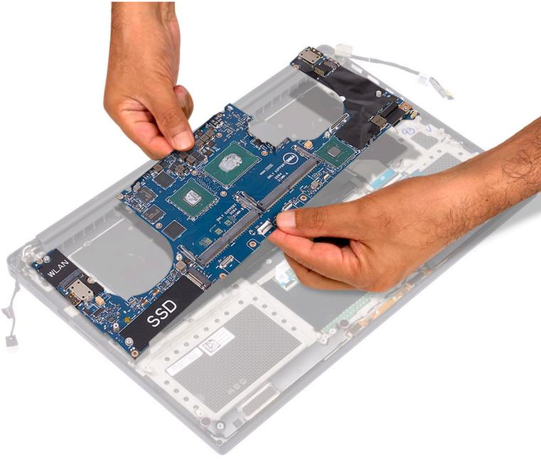
1. 将系统板部件上的螺孔与掌托部件上的螺孔对齐。
